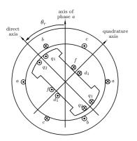
$$\mathbf{L}_{rr} = \left[ \begin{array}{cccc} L_{ff} & L_{fd1} & 0 & 0 \\ L_{fd1} & L_{d1d1} & 0 & 0 \\ 0 & 0 & L_{q1q1} & L_{q1q2} \\ 0 & 0 & L_{q1q2} & L_{q2q2} \end{array} \right]$$
